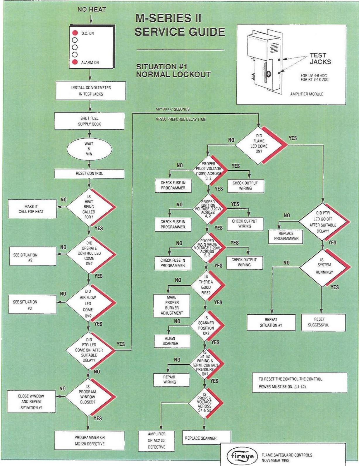
TO RESET THE CONTROL THE CONTROL POWER MUST BE ON. (L1-L2)
